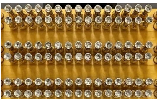
Figura 8 Estado de las puntas de prueba a los 75,000 ciclos.
