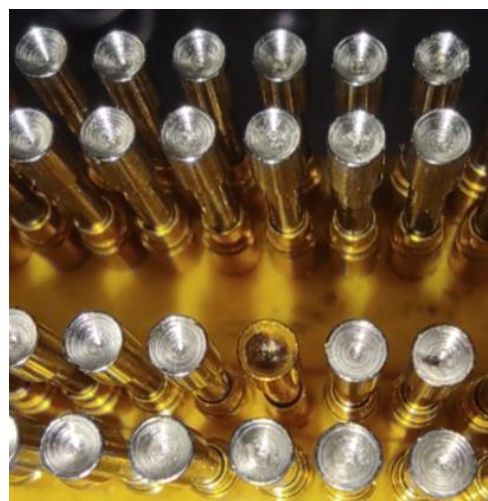
Figura 6 Estado de las puntas de prueba a los 25,000 ciclos.
