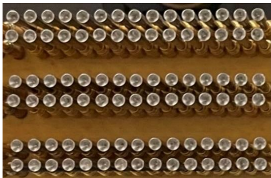
Figura 7 Estado de las puntas de prueba a los 55,000 ciclos.
